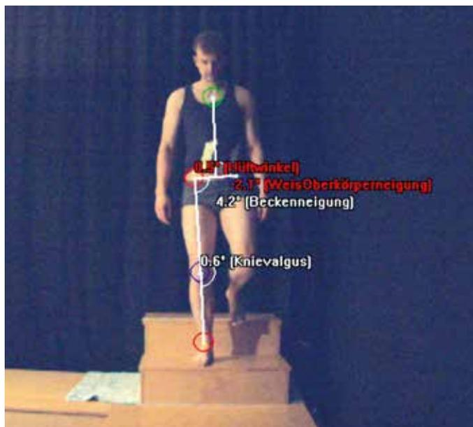
Abb. 2: Anzeige der dynamischen Gelenkwinkel von Oberkörper, Becken, Hüfte und Knie in Echtzeit.
